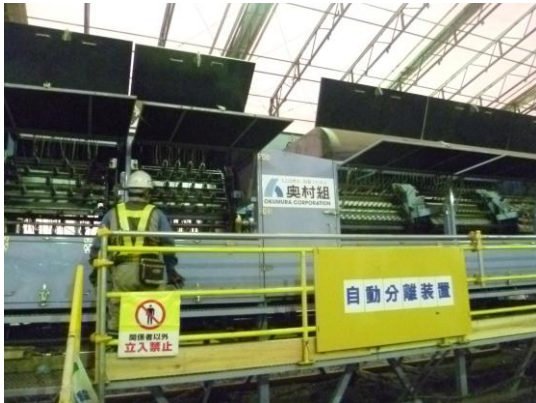
機械による選別（破碎選別プラント内）
