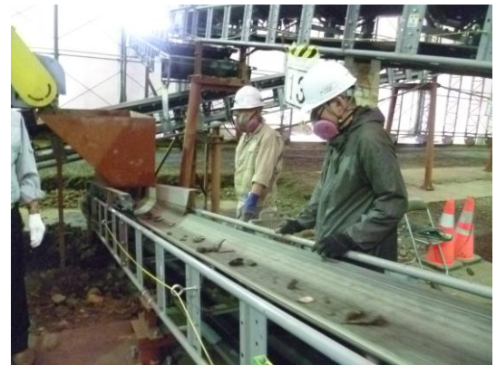
手選別による異物除去（破碎選別プラント内）
